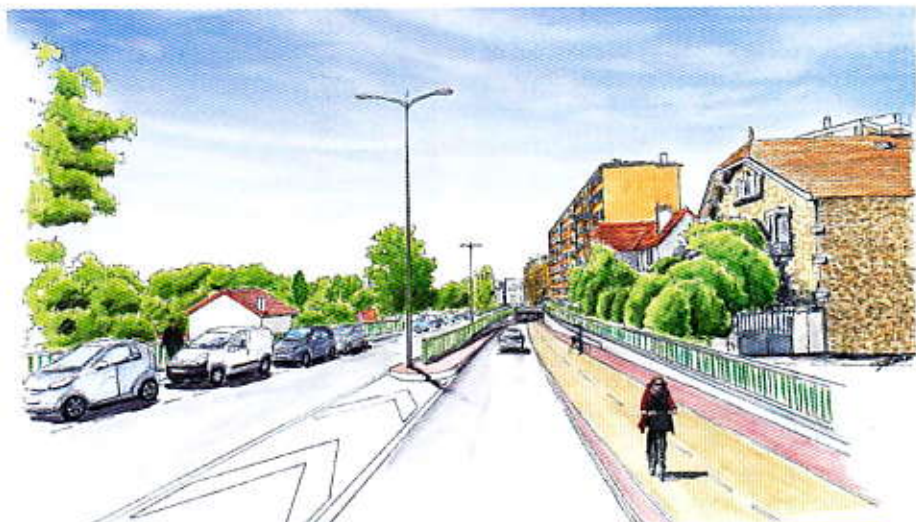
La rue Chapsal, vue depuis le nord : une seule file de circulation sous la trémie pour faire place à la piste cyclable bi-directionnelle
